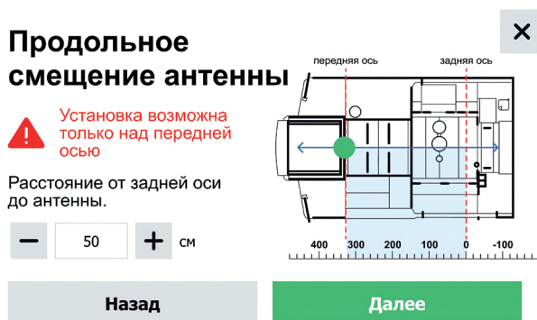
Рисунок 51. Профиль техники. Продольное смещение антенны
