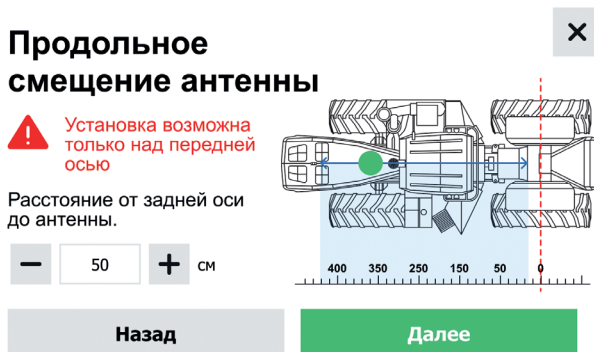
Рисунок 47. Профиль техники. Продольное смещение антенны
