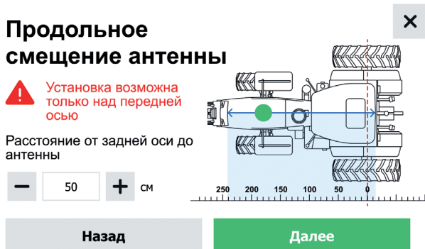
Рисунок 42. Профиль техники. Продольное смещение антенны
