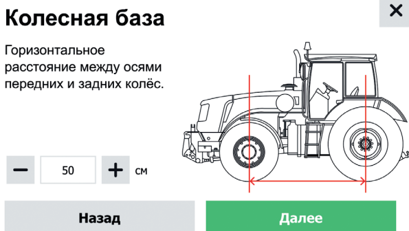
Рисунок 40. Профиль техники. Колесная база
