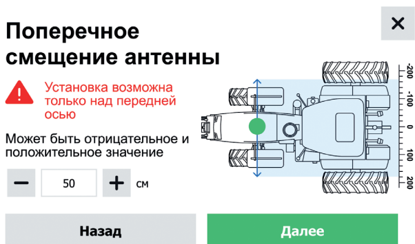
Рисунок 43. Профиль техники. Поперечное смещение антенны
